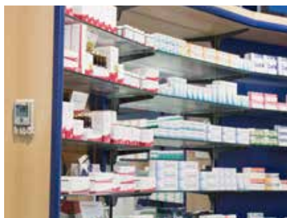
Monitorowania parametrów otoczenia podczas przechowywania leków (testo Saveris 2-H1)
