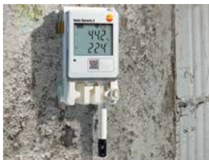
Zapobieganie powstawaniu pleśni - testo Saveris 2-H2 z cyfrowym czujnikiem wilgotności 0572 2154
