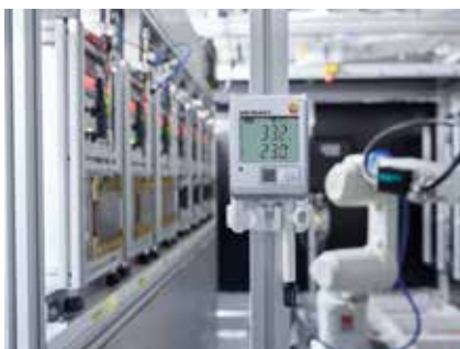
Monitorowanie parametrów powietrza w serwerowniach (testo Saveris 2-T1)
