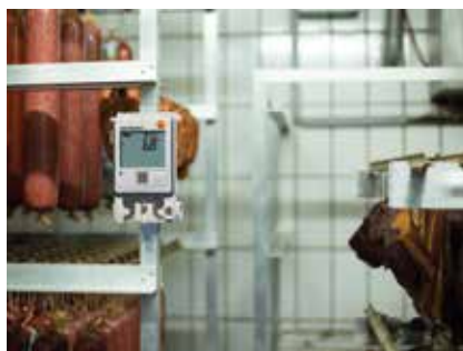
Monitorowanie parametrów otoczenia w chłodniach (testo Saveris 2-T2 z zewnętrzną sondą NTC z czujnikiem otwartych drzwi)
