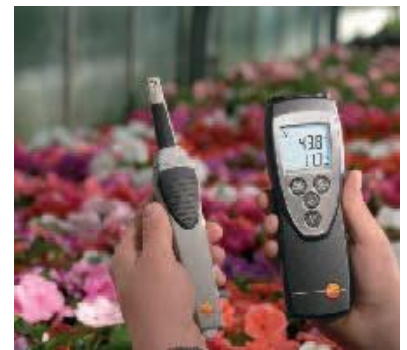
Sonda wilgotności dołączona do uchwyty radiowego np. do monitorowania regulacji klimatyzacji
