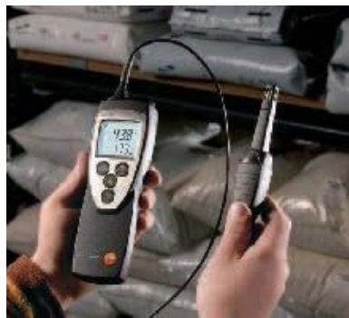
Głowica sondy wilgotności z uchwytem z kablem sondy, np. do monitorowania warunków w magazynie.
